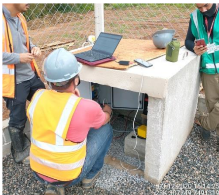
Foto 5 – Configuração do software do sismógrafo. (Data: 02/12/2020).
