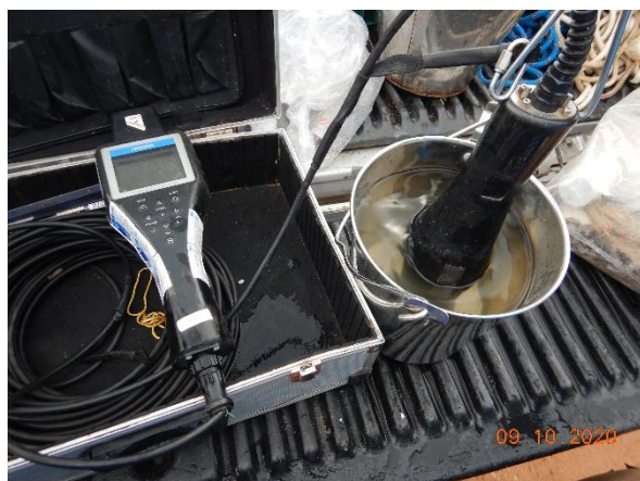
Foto 3.2.1-1: Sonda multiparâmetros utilizada nas medições locais.
