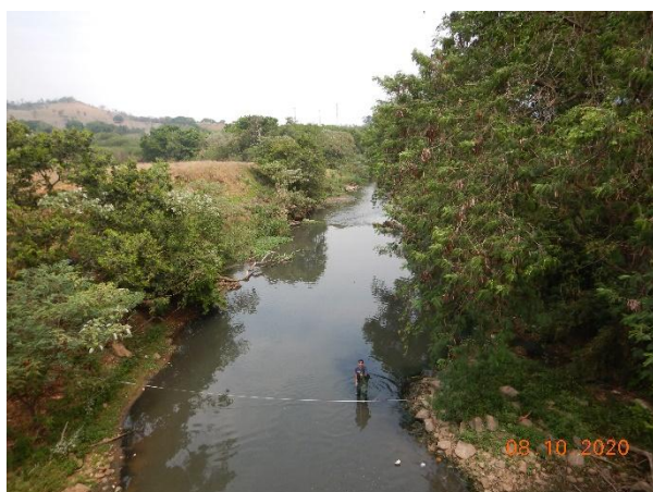
Foto 3.2.1-3 e 3.2.1-4: Medição de vazão do corpo hídrico.
