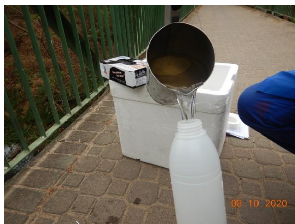
Foto 3.2.1-2: Acondicionamento de amostra de água em frasco específico.
